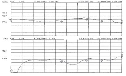
CH1 Nankers 1:-29.500 dB 50.0000 MHz 2:-30.557 dB 10.0000 GHz 3:-28.812 dB 15.0000 GHz 4:-30.538 dB 18.0000 GHz
